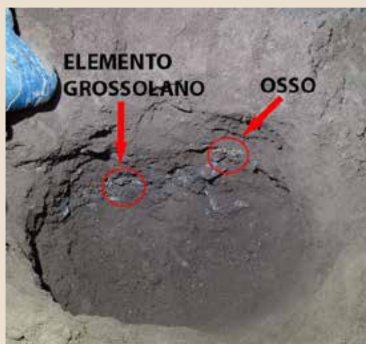
Fig. 6 - Trincea con evidenziata la presenza di elementi grossolani e ossa.
