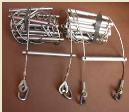
Foto mostrante le parti terminali di due scalette: destra costruita con pioli di LL, sinistra costruita con pioli inox AISI 304.
