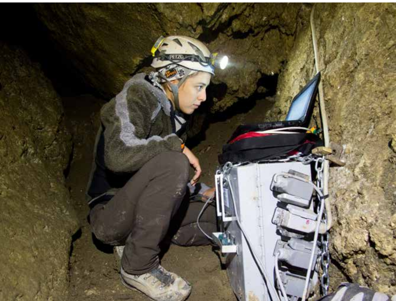
Fig.5 – Scaricamento dei dati dal bat-counter, posizionato nei primi metri della Grotta Coralupi, con cui sono stati indagati i tre varchi naturali di accesso alla cavità per incrociare i dati di transito con quelli della fototrappola IR, installata presso il portello di interdizione alla base della Sala delle Radici.
