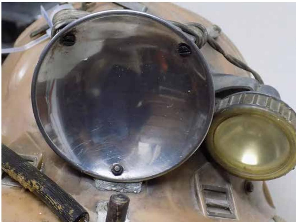
Casco con impianti di illuminazione: parabola inox tornita a lastra, affiancata ad un impianto elettrico di emergenza, stagno (foto di Ettore Scagliarini)
